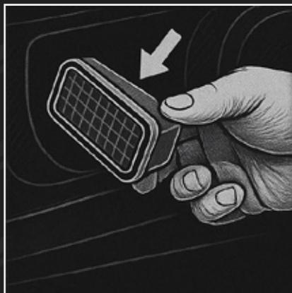
Das neue Modul in die Öffnung einsetzen – es muss bündig sitzen.
